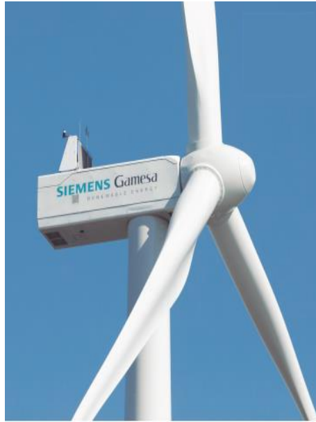
Figura 3.1 – Aerogeneratore Siemens-Gamesa tipo SG 6.2-170
