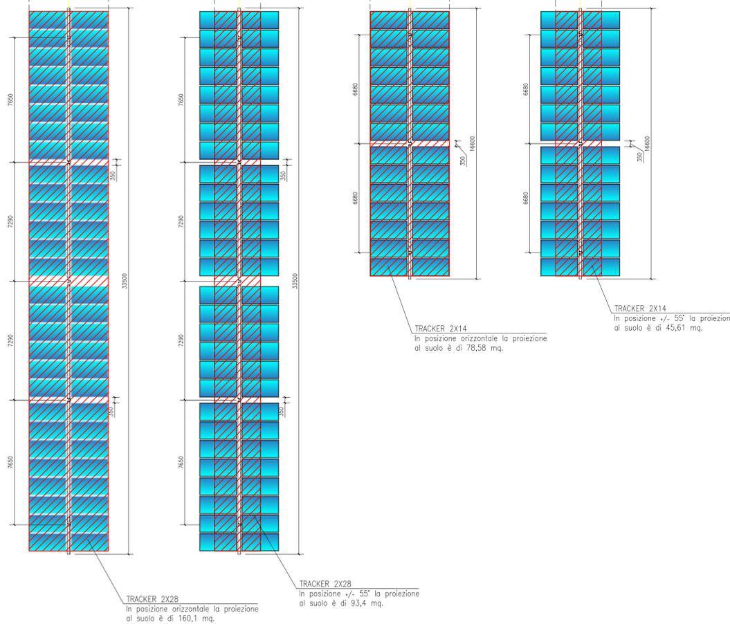
PARTICOLARE TRACKER DI SOSTEGNO DEI PANNELLI FOTOVOLTAICI scala 1:100
