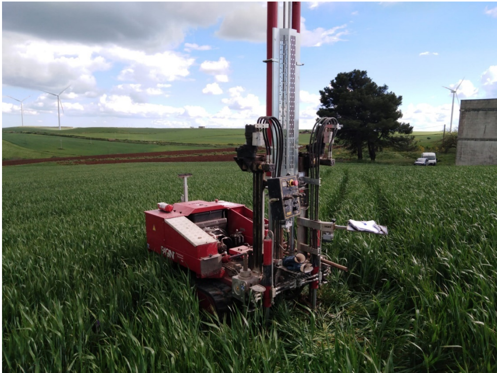
Prova Penetrometrica statica CPT 03
