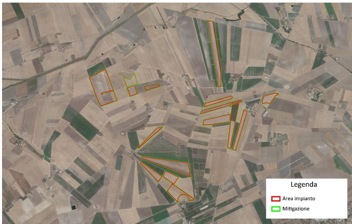
Figura 4.60: Impianto fotovoltaico di Galatina ed individuazione della fascia arborea di mitigazione.
