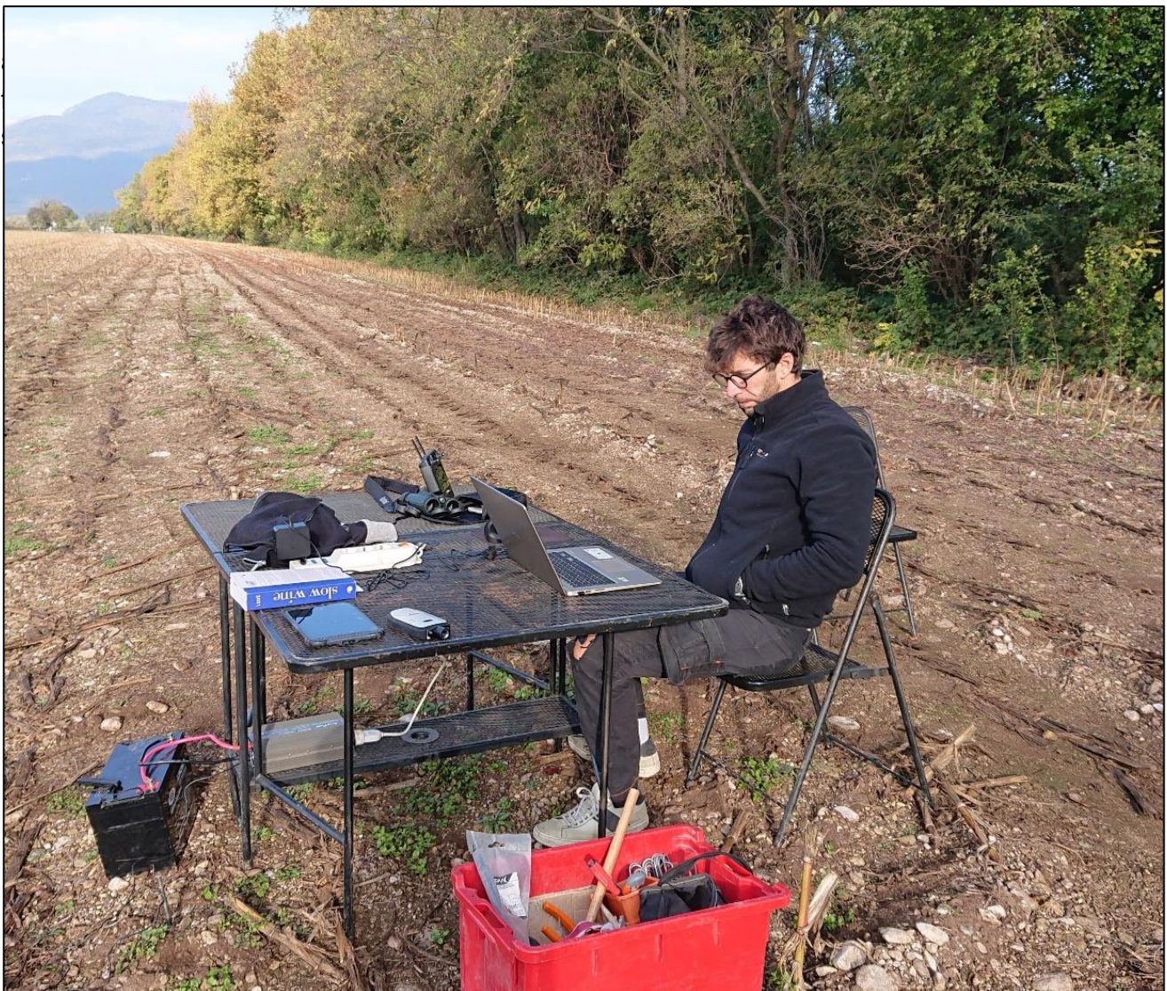
Figura 6 - Set-up della strumentazione magnetometrica in campo
