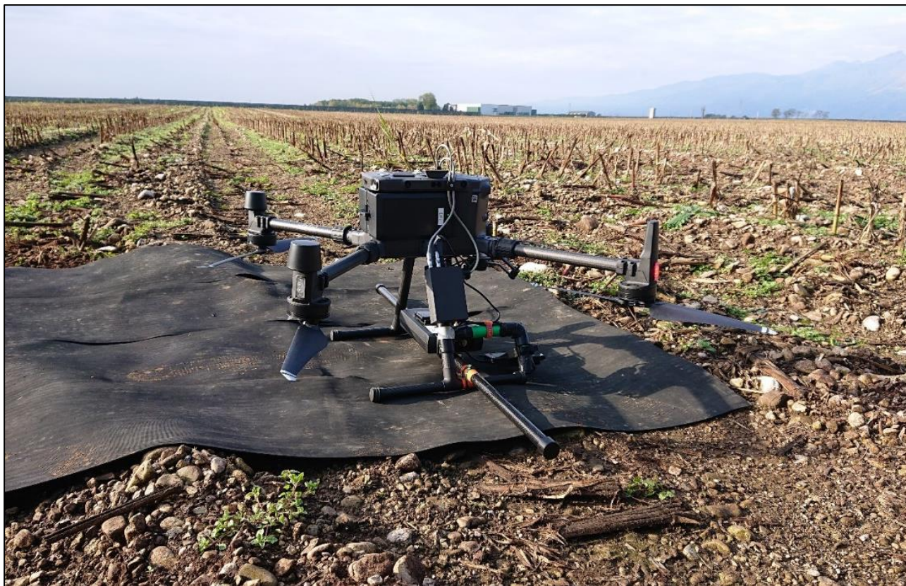
Figura 7 - DJI Matrice 300 RTK equipaggiato con MagDrone R3
