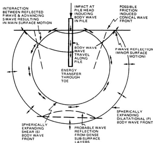
Come si evince dalle immagini precedenti il palo va due metri in profondità e i pali sono considerati Piccoli (I pali di piccolo diametro sono quelli di diametro compreso tra 80 e 300 mm, hanno lunghezze prevalentemente comprese tra 5 e 20 m). La palificazione di questi elementi provoca vibrazioni che possono essere avvertite a massimo 5 m di distanza. Come si
