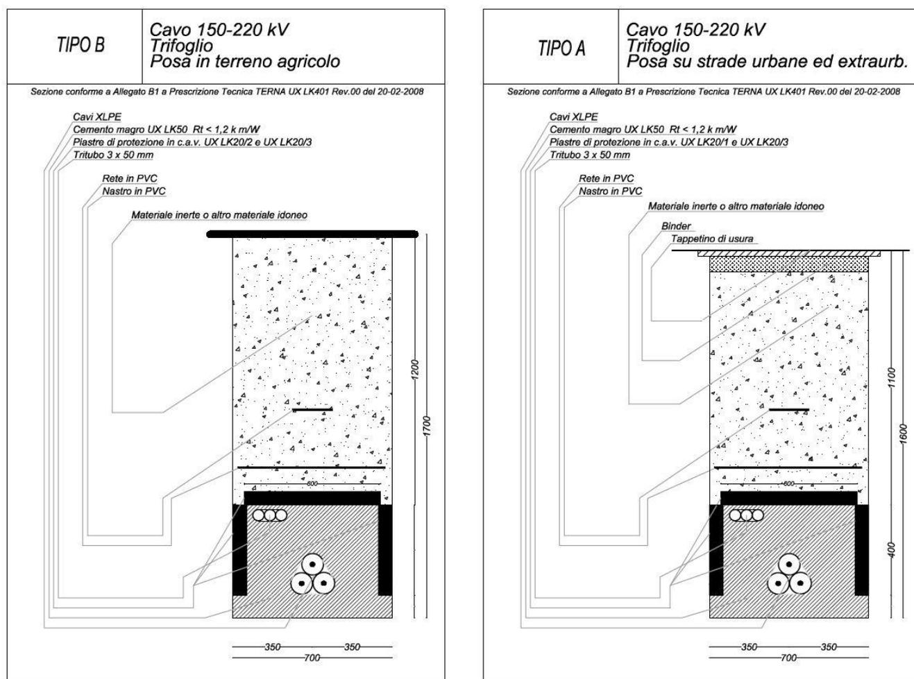
**Figura 7 - TIPOLOGIE SEZIONI DI SCAVO LINEE AT ESTERNE ALL'IMPIANTO**
