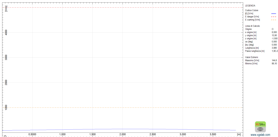
Profilo Campo Elettrico ad altezza 0,25 m
