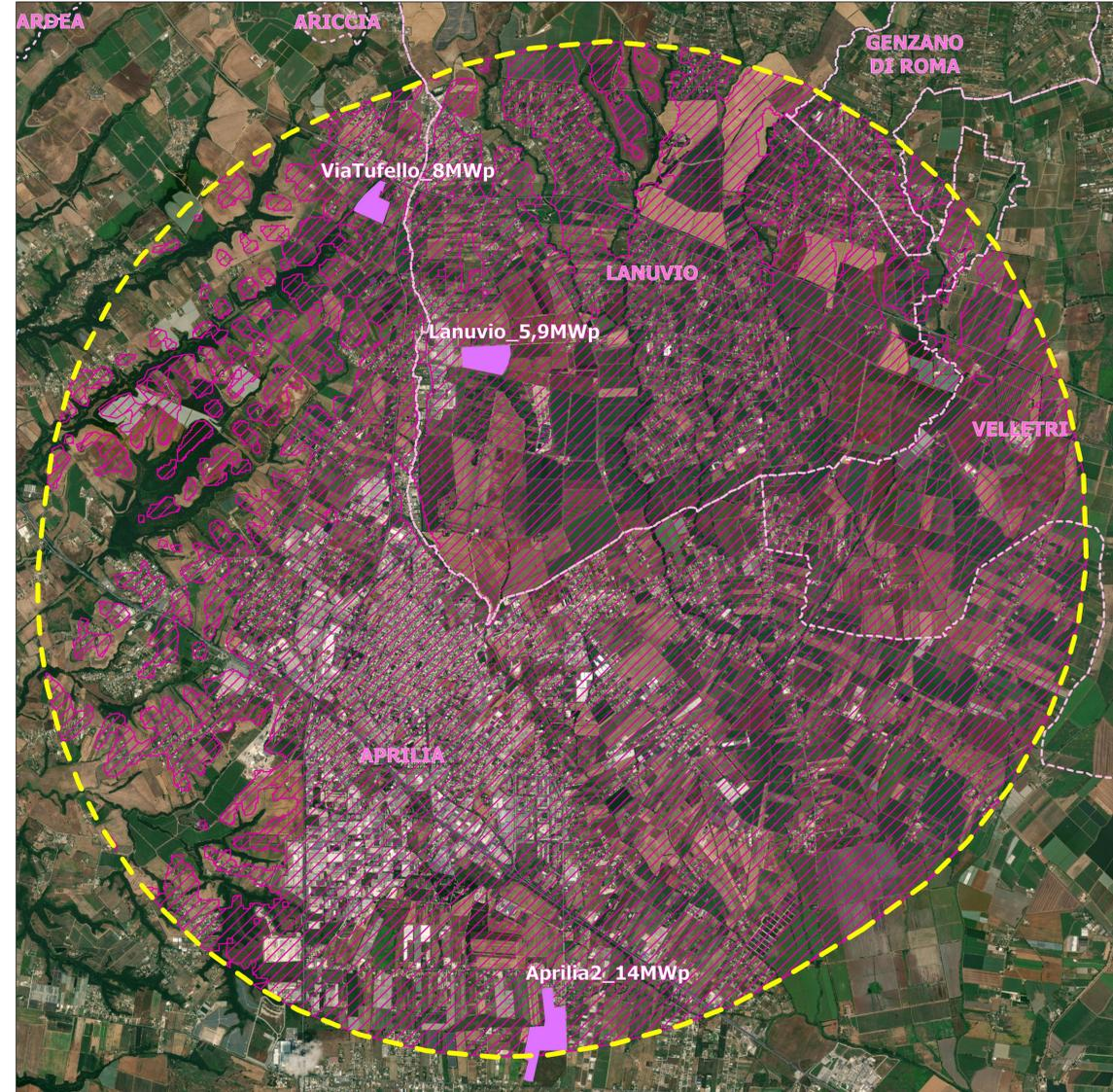
La planimetria illustra le aree da cui è orograficamente possibile interferire visivamente con i due campi fotovoltaici allo stato attuale dei luoghi. Si specifica che il campo fotovoltaico Lanuvio\_5,9MWp è esistente mentre i campi di ViaTufello\_8MWp e Aprilia2\_14MWp sono stati autorizzati in data 14/07/2021 ed in data 07/07/2022, con pareri favorevoli con prescrizioni. La porzione del grafico in rosa indica l'indice di visibilità.
