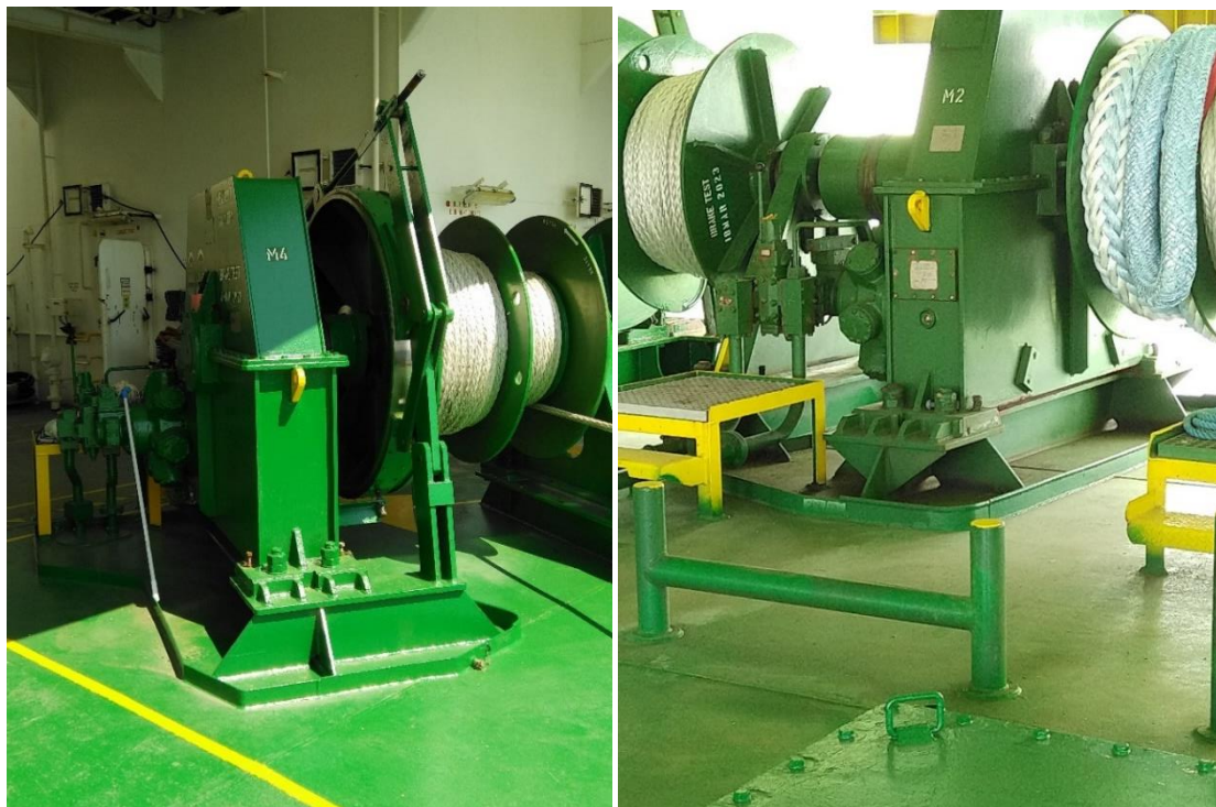
Figura 4 – Area impermeabile e cordolata con tappo al di sotto dei Verricelli idraulici dei ganci di ormeggio (punto 4.c)
