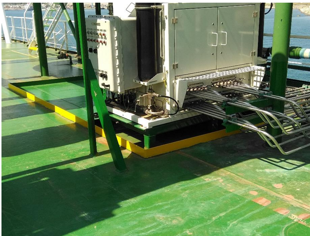
Figura 2 – Area impermeabile e cordolata con tappo al di sotto della centralina olio idraulico (punto 4.a)
