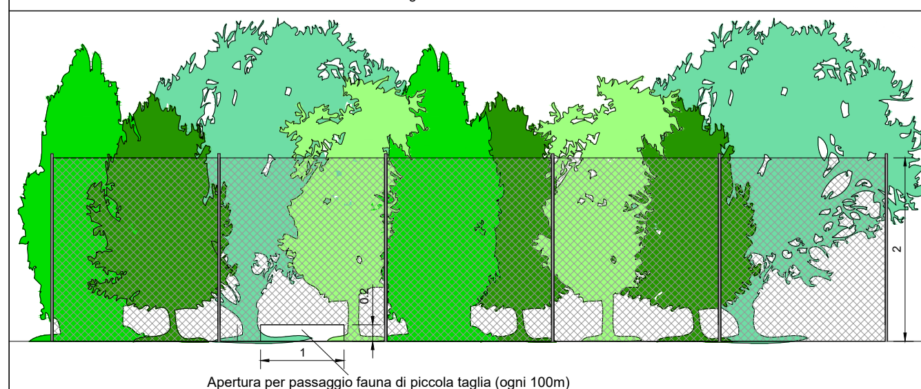
Apertura per passaggio fauna di piccola taglia (ogni 100m)
