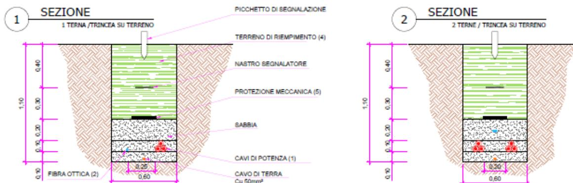
Fig.6-Tipologia posa a trifoglio cavi MT ad uno e due cavi su tracciati non asfaltati
