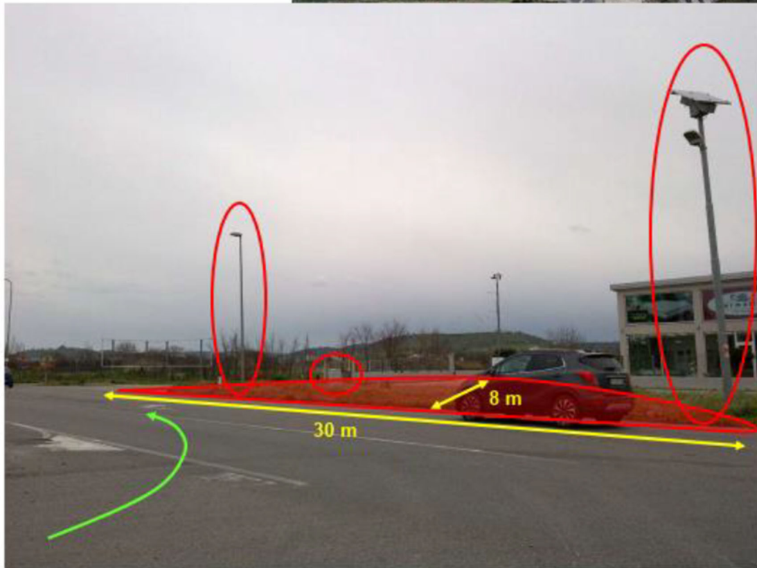
Fig.27-Rimozione ostacoli ed allargamenti sede viaria
