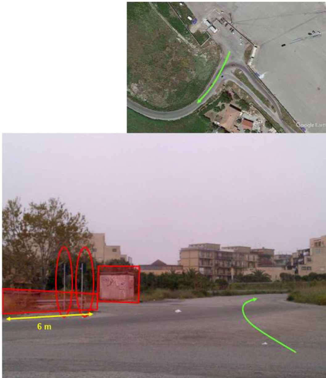
Fig.19-Rimozione temporanea segnali stradali, guard rail e cabina
