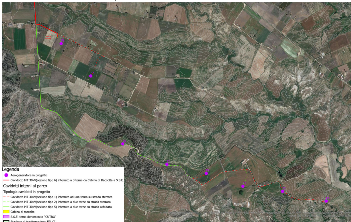
Fig.22-Progetto cavidotto su ortofoto
