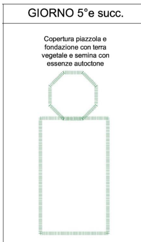
Figure 3 - Fasi di smontaggio degli aerogeneratori
