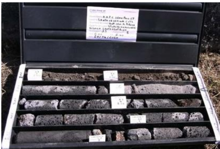
Figura 1 - Sondaggio verticale con carotiere
