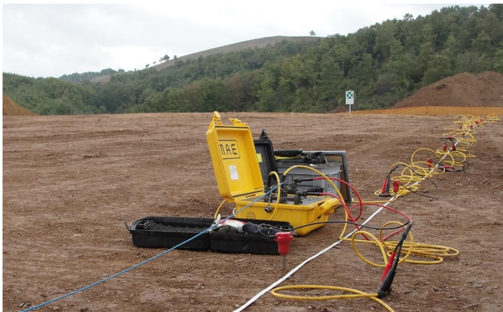
Figura 2 - Indagine sismica - Down Hole
