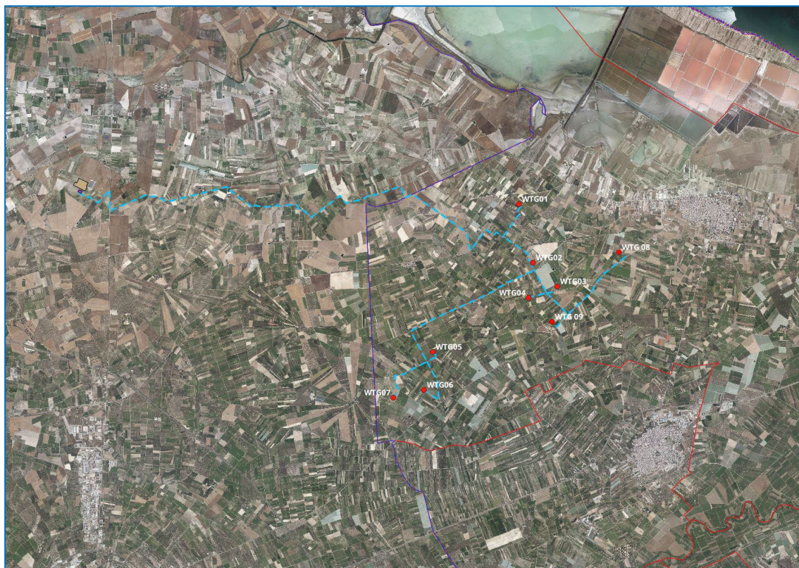
Figura 2 - Ipotesi Layout a 9 aerogeneratori
