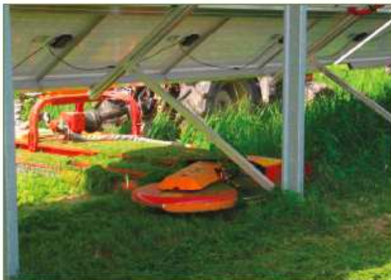
Esempio di sfalcio della vegetazione erbacea al di sotto dei pannelli
