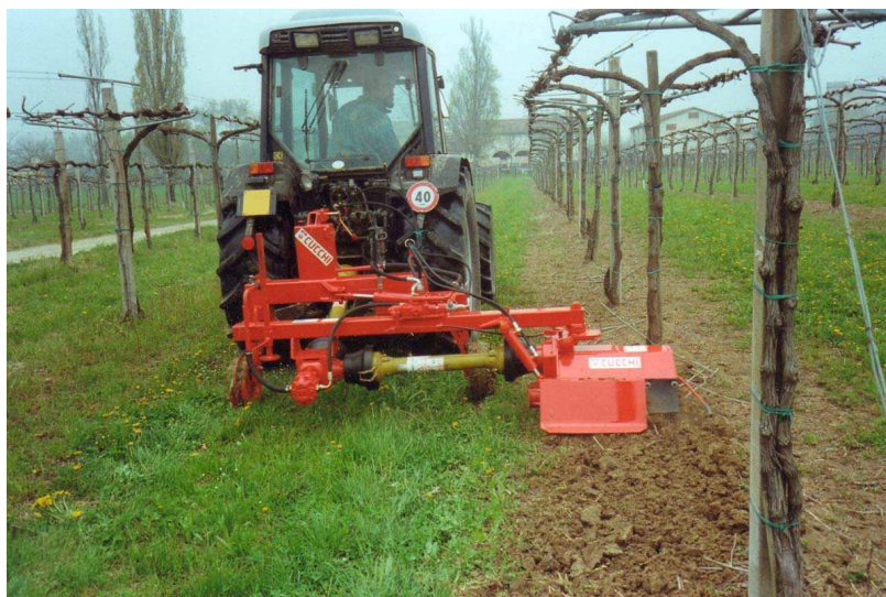
Esempio di fresatrice interceppo per le lavorazioni in corrispondenza dei sostegni (Foto: Officine meccaniche CUCCHI MACCHINE AGRICOLE)
