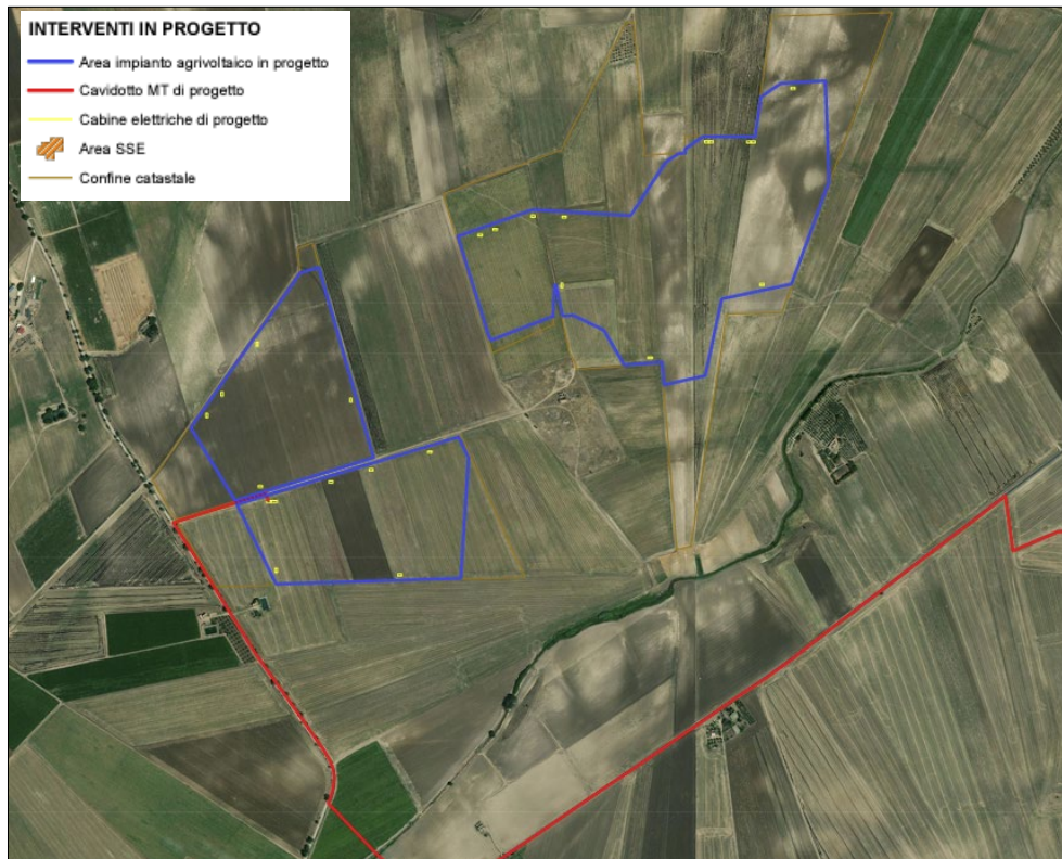
Figura 24 - Layout impianto agrivoltaico definitivo
