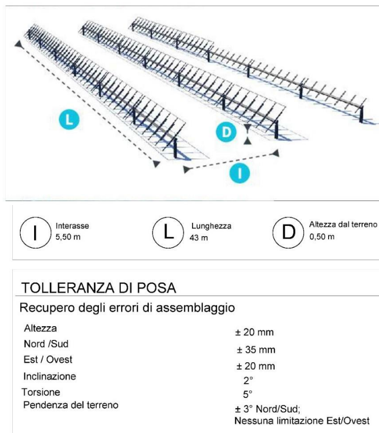
Fig. 36 - Schema esplicativo del sistema di sostegno dei pannelli e dell'inseguitore solare
