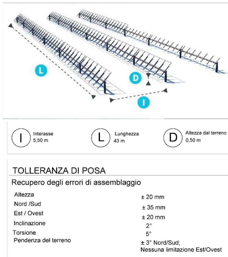
**Fig. 6 - Schema esplicativo del sistema di sostegno dei pannelli e dell'inseguitore solare**
