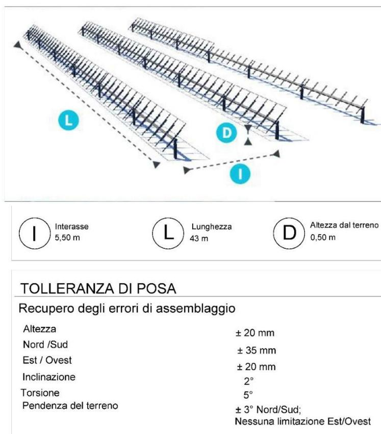
**Fig. 23- Schema esplicativo del sistema di sostegno dei pannelli e dell'inseguitore solare**
