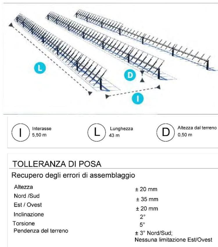
Fig. 44 - Schema esplicativo del sistema di sostegno dei pannelli e dell'inseguitore solare
