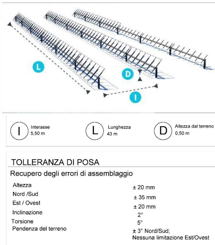
**Fig. 12 - Schema esplicativo del sistema di sostegno dei pannelli e dell'inseguitore solare**
