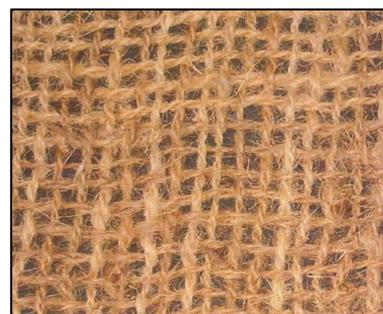
Figura 22 – Particolare geostuoia in fibra di cocco per il rivestimento dei fossi di guardia
