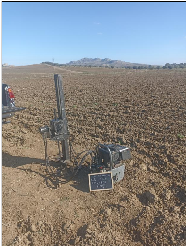
(Foto n° 9 – Prova penetrometrica Partanna_01 - Din_09)
