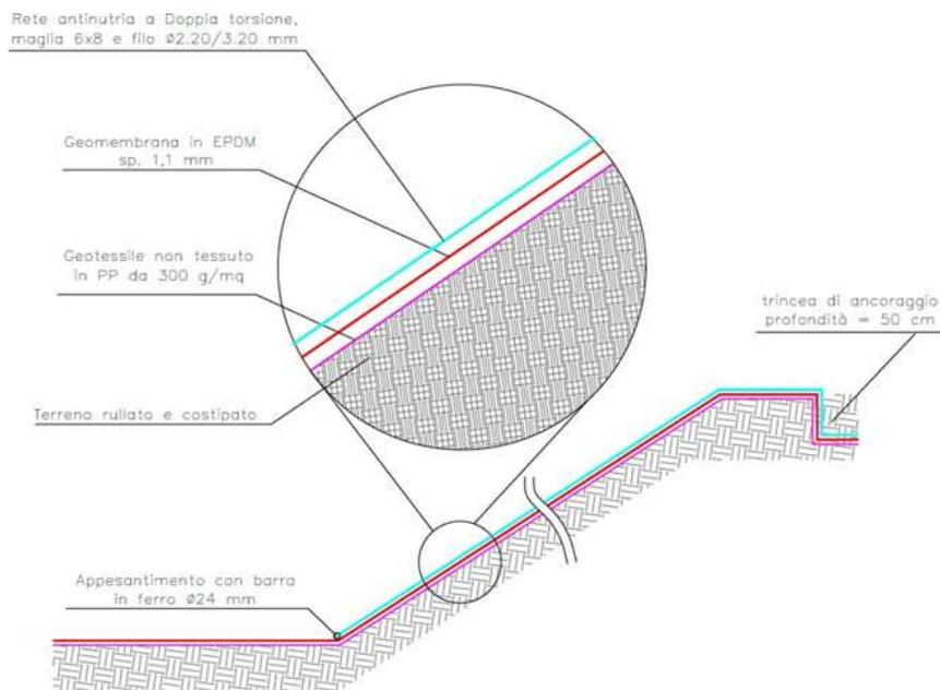
Le verifiche periodiche e le manutenzioni ordinarie dell'invaso dovranno accertare l'integrità dell'impermeabilizzazione del fondo e dei fianchi e provvedere al rinfranco dello strato di argilla compattata ove necessario.
