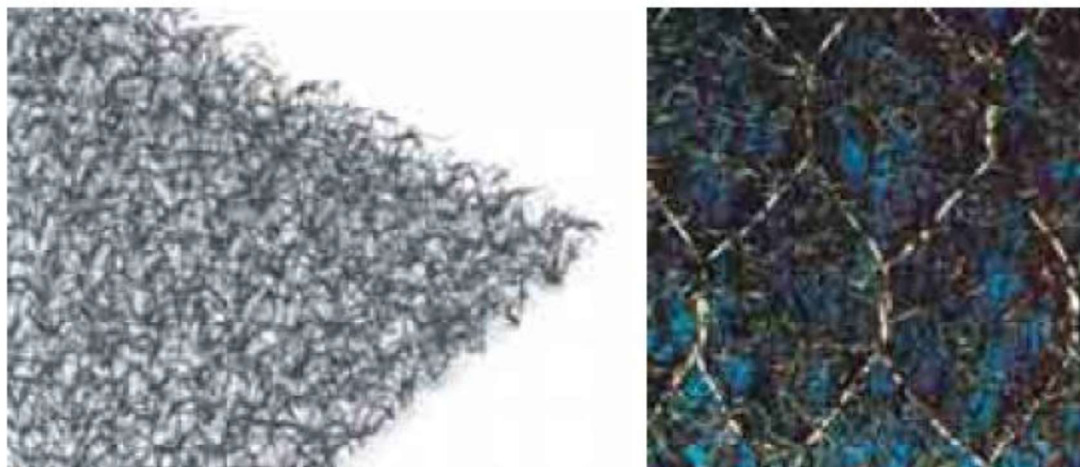
Figura 6 - A sinistra - geostuoia tridimensionale in fibred di polipropilene. A destra geotetridimensionale rinforzata con unarete metallica a doppia torsione amaglie esagonali.
