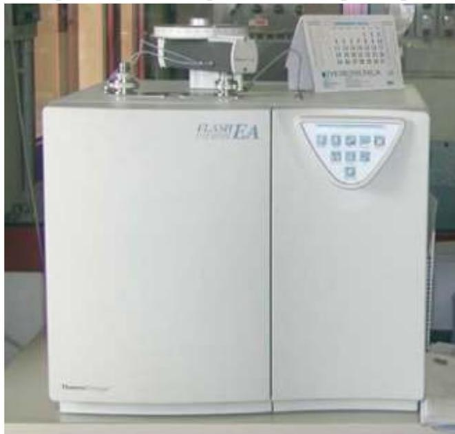
Analizzatore elementare di azoto
