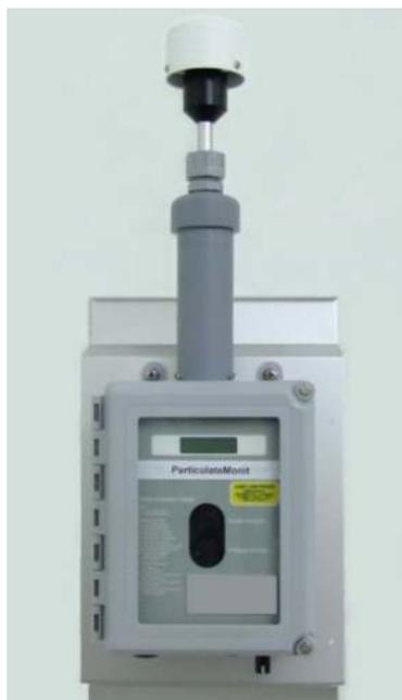
Sonda per le polveri sottili in atmosfera
