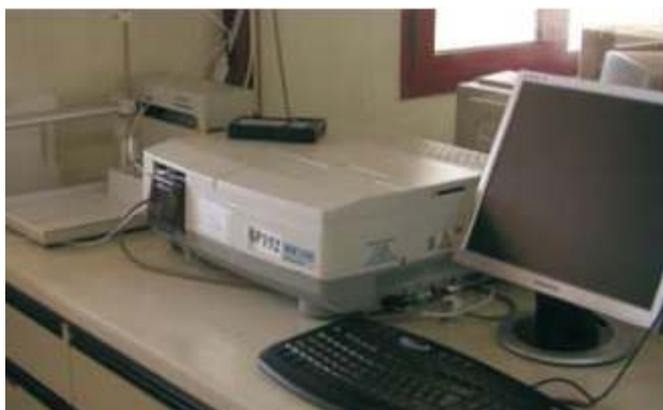
Spettrofotometro per l'analisi colorimetrica del fosforo assimilabile
