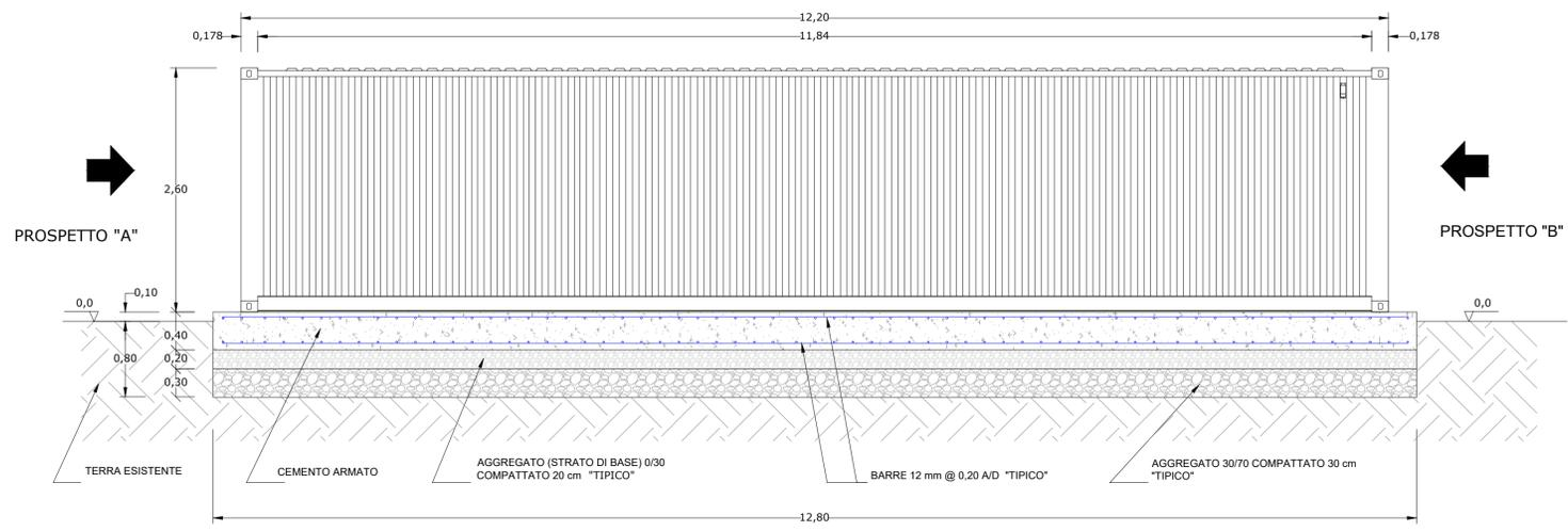
CABINA STOCCAGGIO MATERIALE (PROSPETTO)
