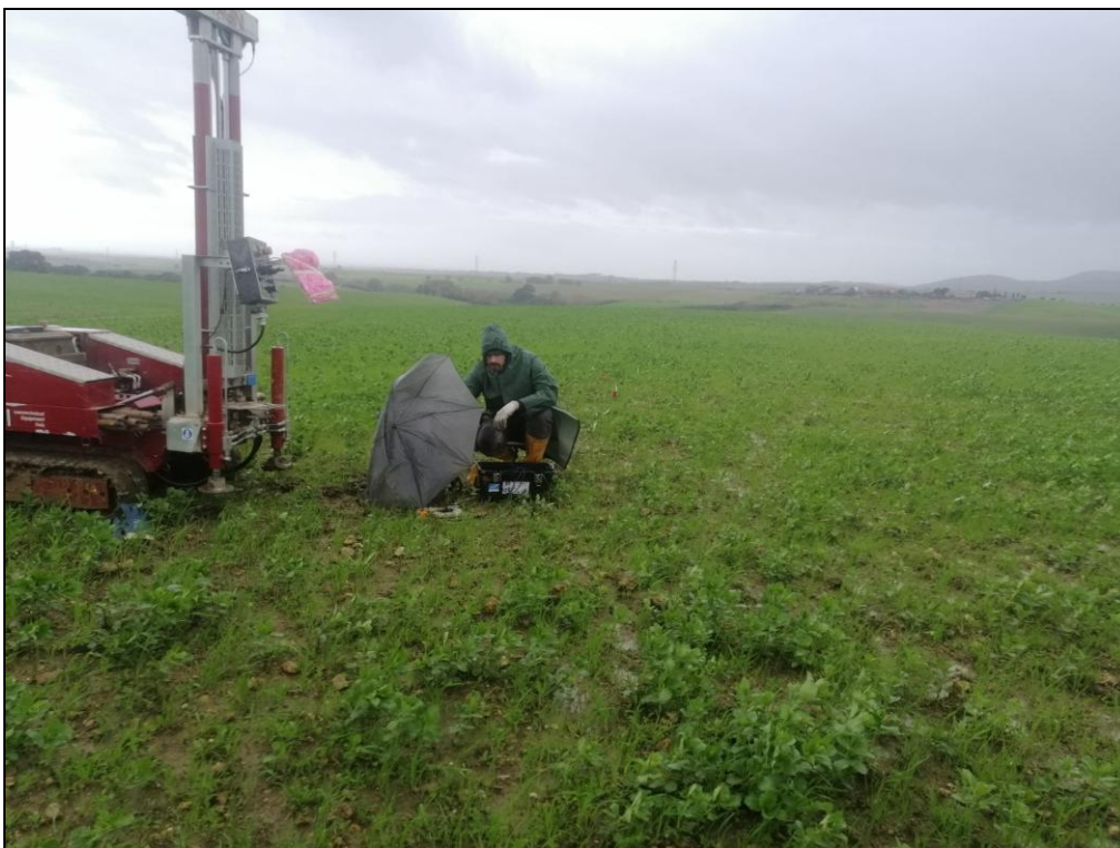
Esecuzione profilo sismico a rifrazione 3-3'
