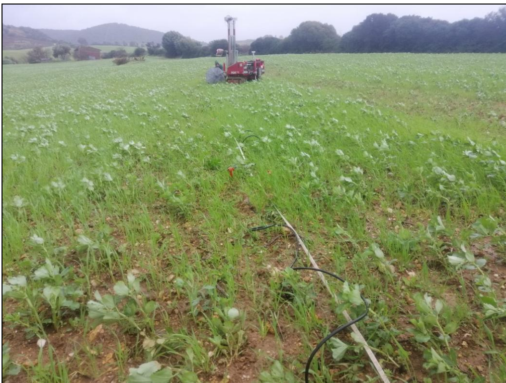
Esecuzione profilo sismico a rifrazione 2-2'
