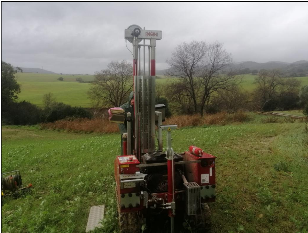
Esecuzione prova penetrometrica dinamica continua – DPSH 4
