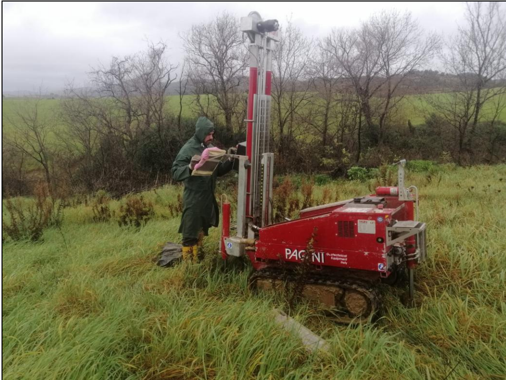
Esecuzione prova penetrometrica dinamica continua – DPSH 6
