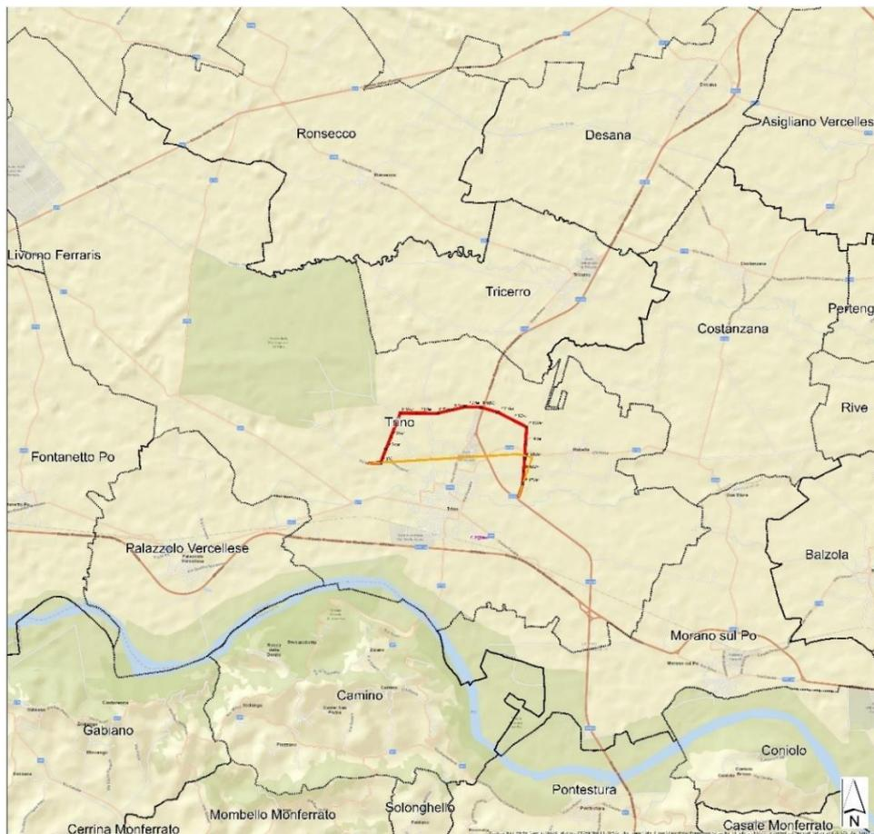
**Figura 1: Corografia di inquadramento del progetto (in rosso la Variante in progetto, in arancio la linea di prevista dismissione)**
