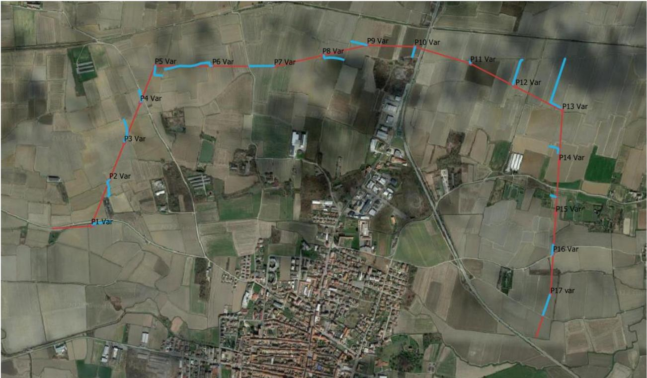
**Figura 33: - Accessi su strada esistente verso i sostegni da realizzare (in blu).**
