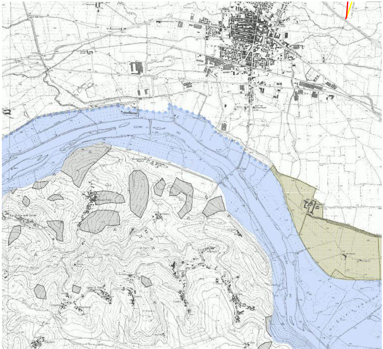
Estratto del Foglio 157 – Sez. I dell'Atlante dei rischi idraulici e idrogeologici del PAI. In rosso è indicato il tracciato in progetto, mentre in giallo, il tracciato oggetto di demolizione.
