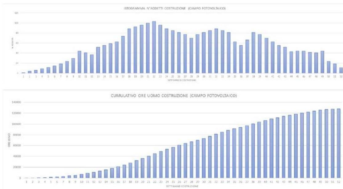
**Fig. 35 – Iistogramma n° addetti costruzione / cumulativo ore uomo costruzione (campo agrivoltaico)**
