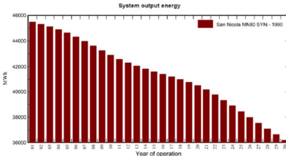
**Fig. 34 – Producibilità dell’impianto con degrado moduli (30 anni)**
