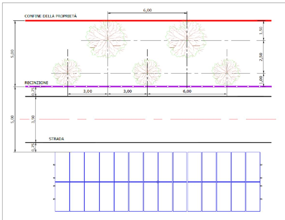
**Fig. 21 – Fascia di piantumazione/mitigazione vista in pianta**
