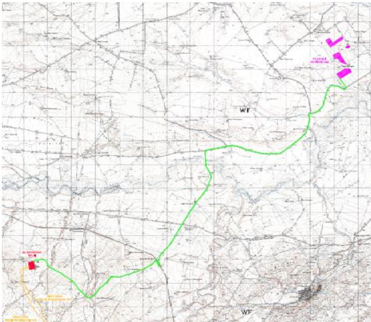
**Fig. 27 – Cavidotto AT di collegamento verso la RTN**
