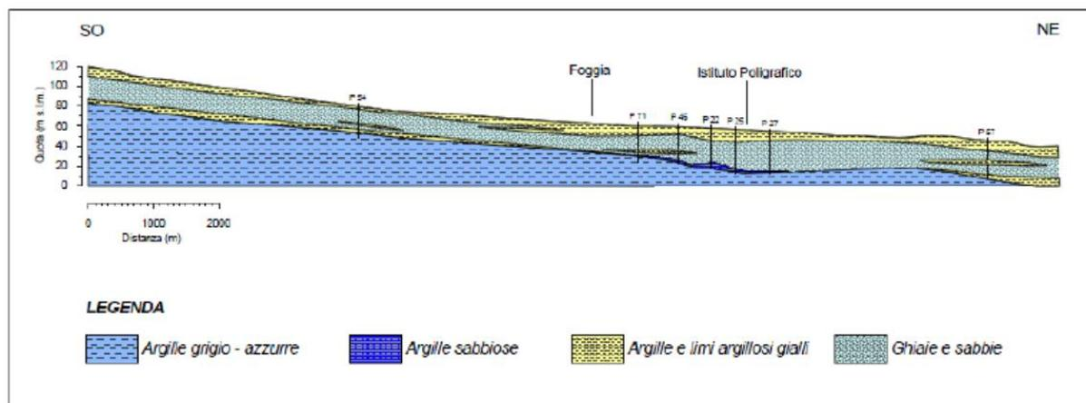
**Fig. 9 – Sezione geolitologica del Tavoliere in corrispondenza del tratto medio-basso del bacino idrografico del Torrente Cervaro (da Sollitto, 2006)**
