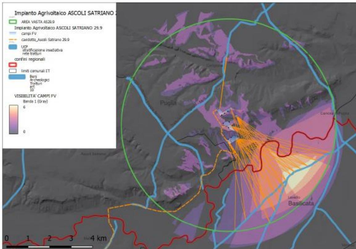
**Fig. 16 - Tracciati di intervisibilità tra la rete dei trattori e le aree di impianto rilevati in AVIC 3km**
