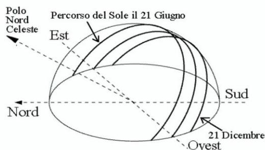
**Fig. 36 - Movimento apparente del disco solare per un osservatore situato ad una latitudine nord attorno ai 45°. Per tutte le località situate tra il Tropico del Cancro e il Polo Nord Geografico il disco solare non raggiunge mai lo zenit.**
