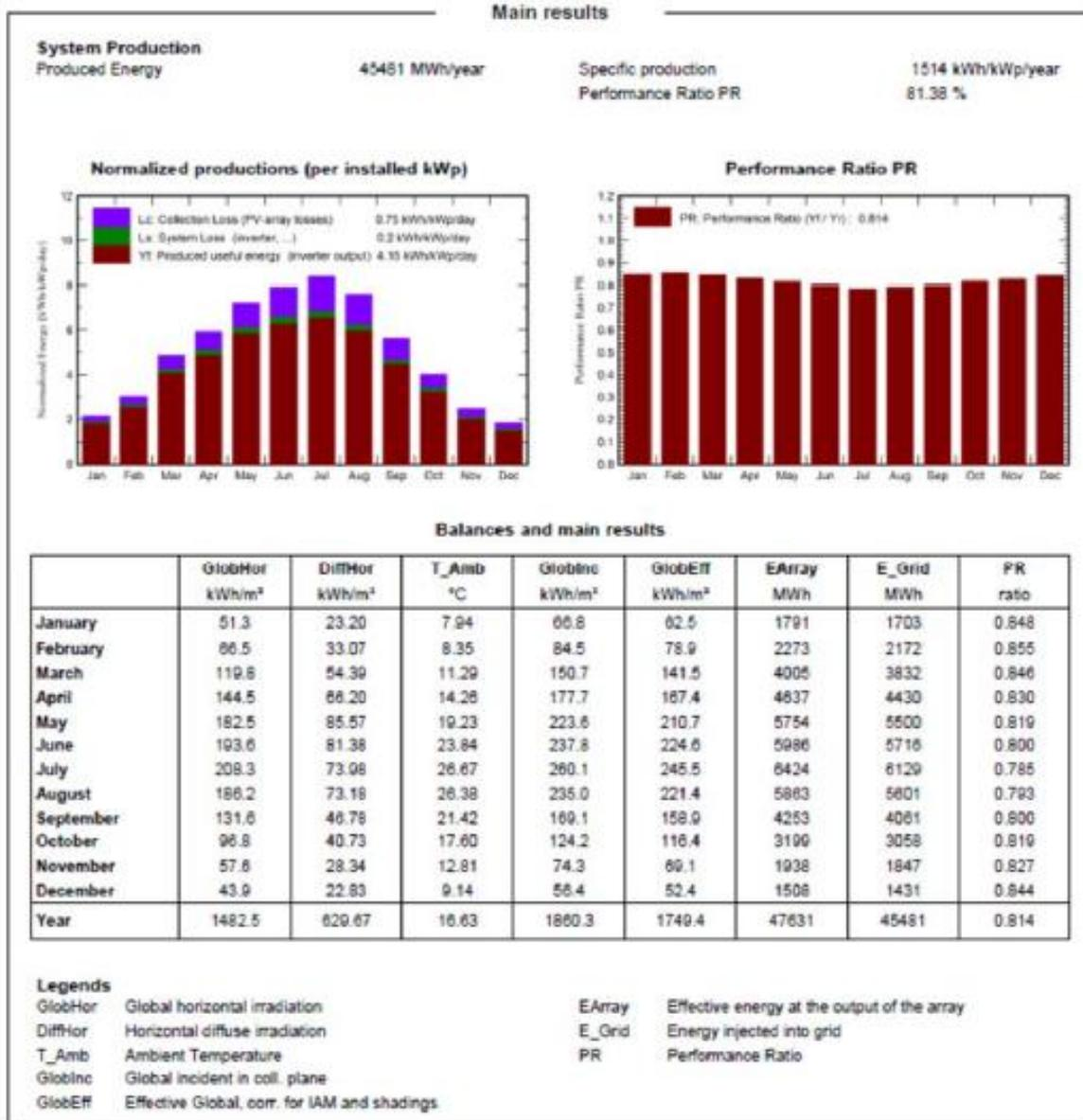
**Fig. 33 - Risultati di calcolo (Fonte: PVsyst - Meteonorm)**
