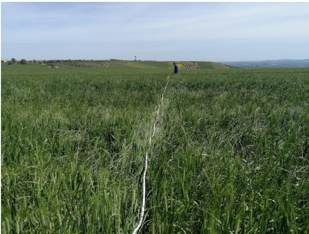
Esecuzione profilo sismico a rifrazione 3-3' e Masw 2 sullo stesso stendimento
