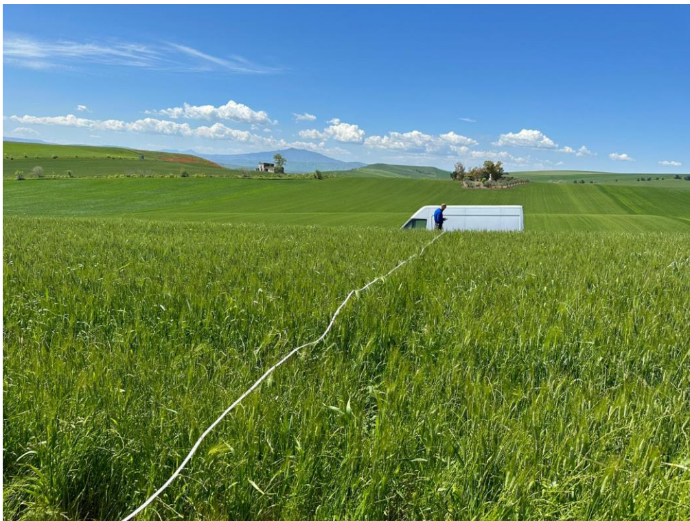
Esecuzione profilo sismico a rifrazione 5-5' e Masw 3 sullo stesso stendimento
