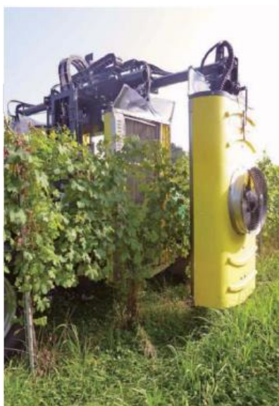
Foto 1 - pompa irroratrice a polverizzazione pneumatica con diffusore anti-deriva
