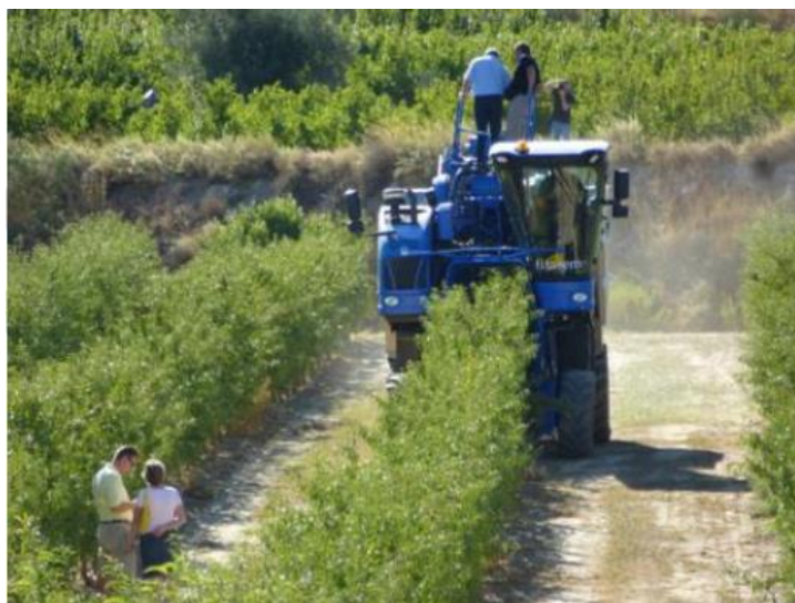
Foto 2 - Macchina scavallatrice durante le operazioni di raccolta in mandorleto superintensivo a siepone
