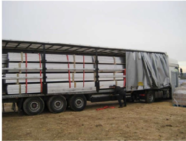
Figura 20 | Autoarticolato tipo per consegna struttura portante
