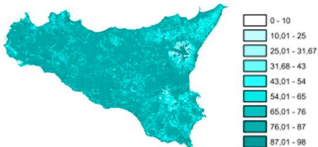
Figura 8: Stralcio della Tav. 7 allegata alla Relazione Generale del P.A.I, con griglia areale del coefficiente CN
