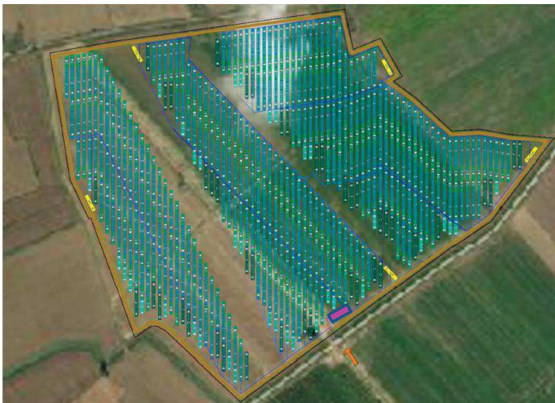
Figura 3– Disposizione dell'impianto fotovoltaico
