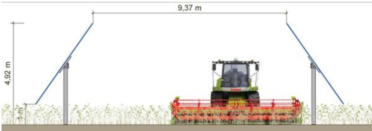
**Figura 49: Particolare sezione trasversale con macchina agricola in azione.**
