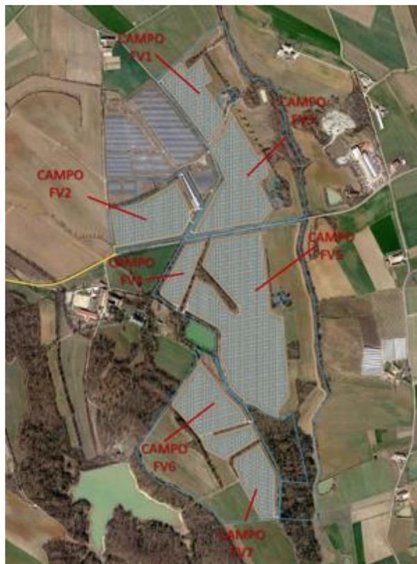
Figura 47:Layout di progetto. In blu l'area catastale in disponibilità del proponente, in rosso le aree recintate occupate dalla componente fotovoltaica.
