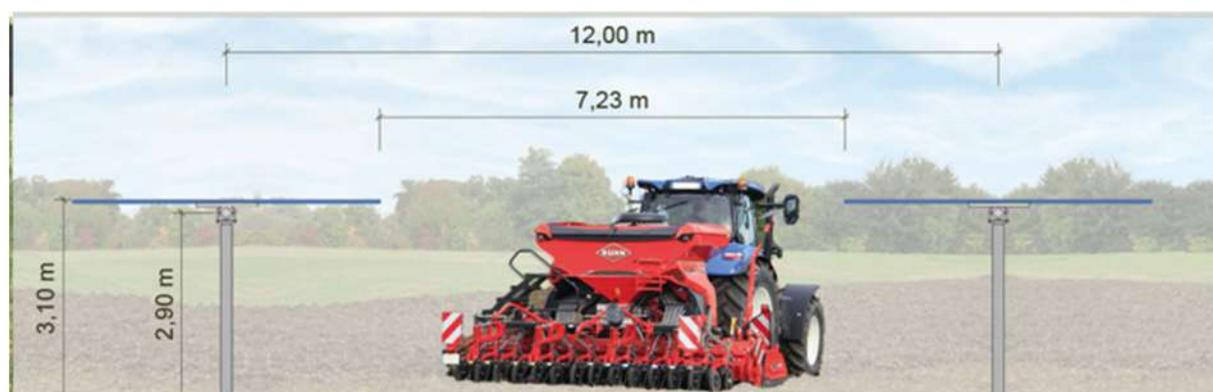
Figura 3.13: Particolare Sezione Trasversale con Passaggio di una Seminatrice
