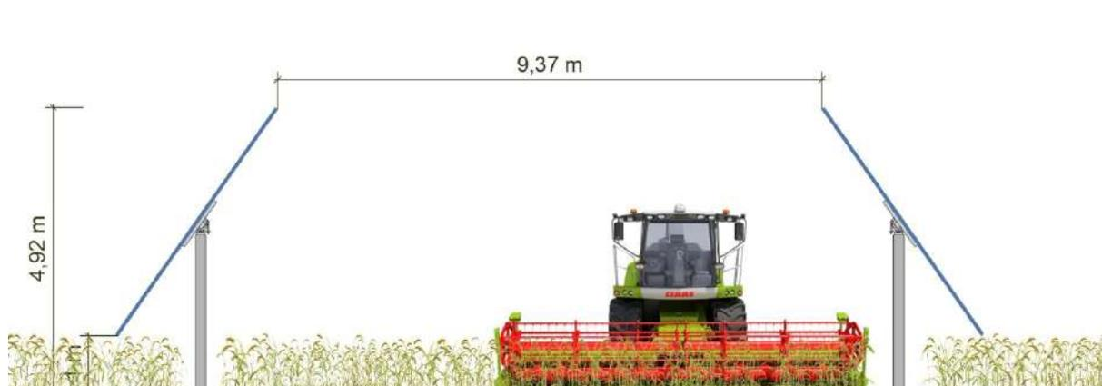
Figura 3.12: Particolare Sezione Trasversale con Macchina Agricola in Azione
