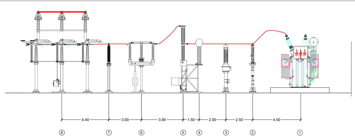
PIANTA E SEZIONE BB' - TRASFORMATORE scala 1: 100
