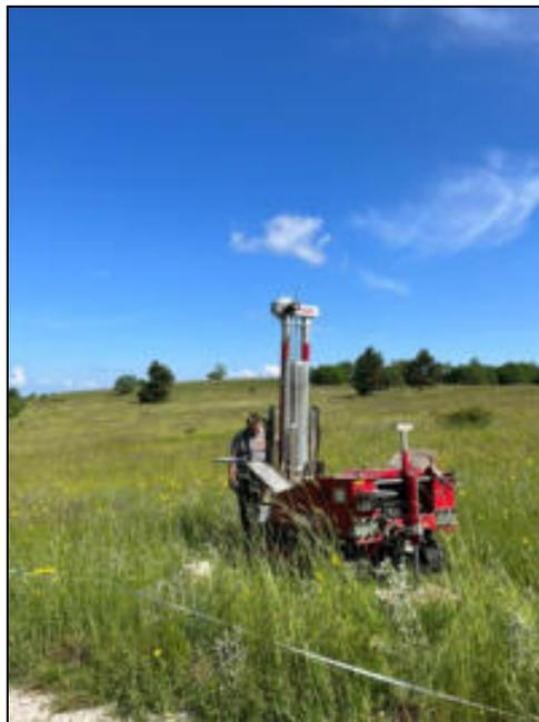
Foto 2: Esecuzione prova penetrometrica DPSH2 sul sito WTG VT05.
