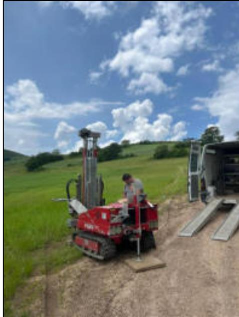
Foto 1: Esecuzione prova penetrometrica DPSH1 sul sito WTG VT01.
