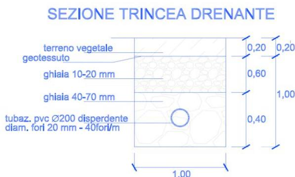
Figura 6. Sezione trasversale della trincea drenante.
