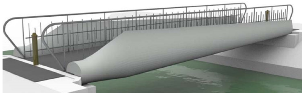
Figura 9 - Esempio riutilizzo pala eolico
