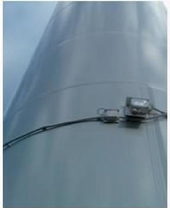
Figura 81 - Sistema alert chiroterri
