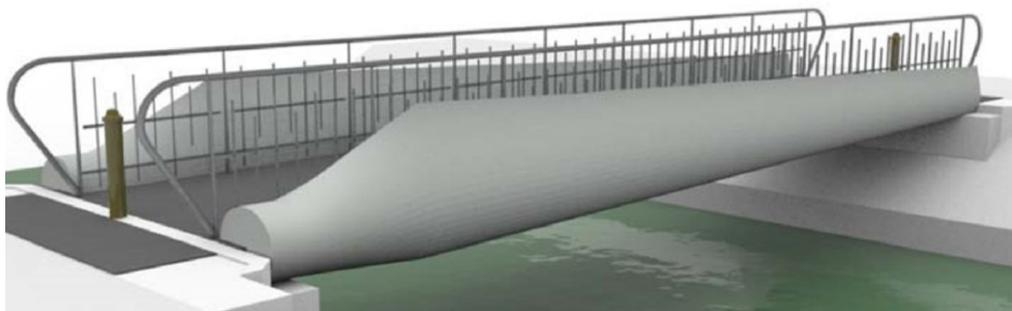
Figura 15 - Esempio riutilizzo pala eolica
