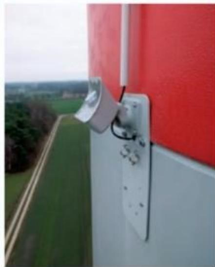
Figura 78 - Sistema radar chiroterri
