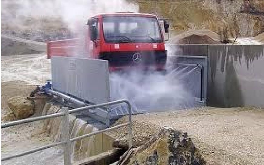
Figura 84 - Sistema abbattimento polveri mediante bagnatura ruote mezzi di lavoro
