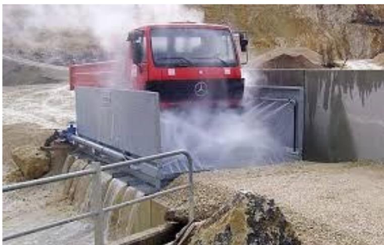
Figura 10 - Lavaggio ruote mezzi di lavoro
