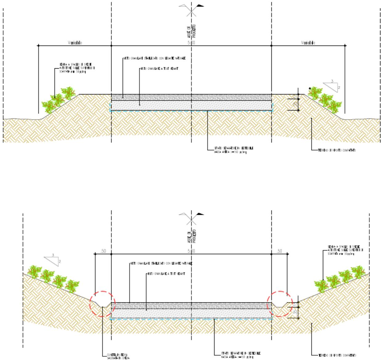
Figura 3: sezione stradali tipo rilevato strada
