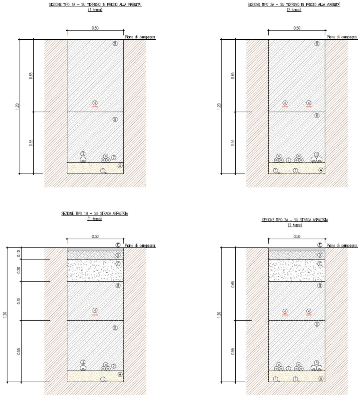
Figura 4 - sezioni tipo 1A/2A e 1A/1B cavidotto
