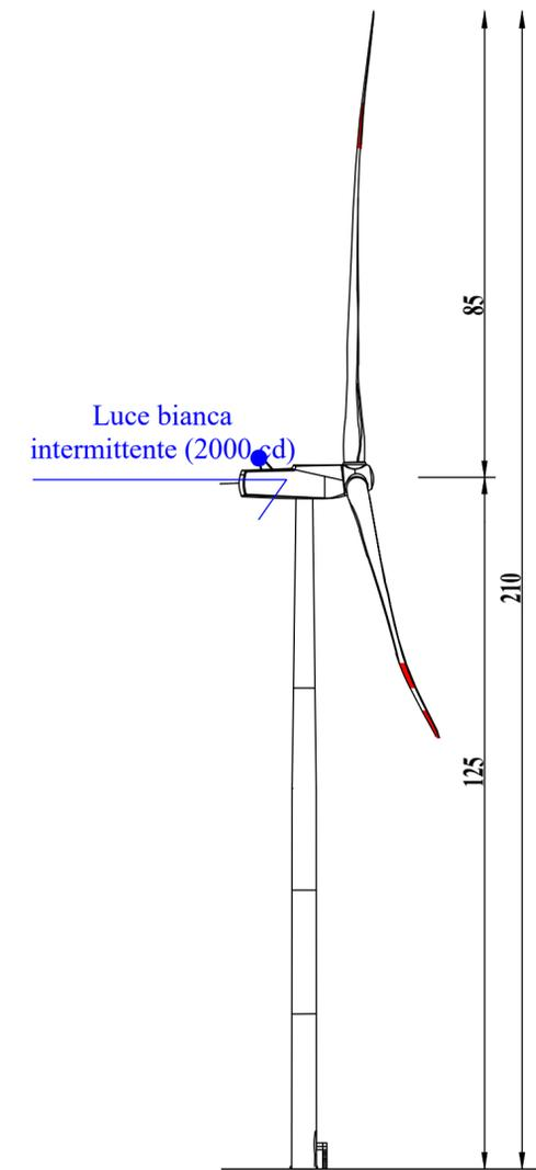
**TUTTI GLI AEROGENERATORI SARANNO PROVVISI DI SEGNALAZIONE CROMATICA (DIURNA) E LUMINOSA (NOTTURNA)**
