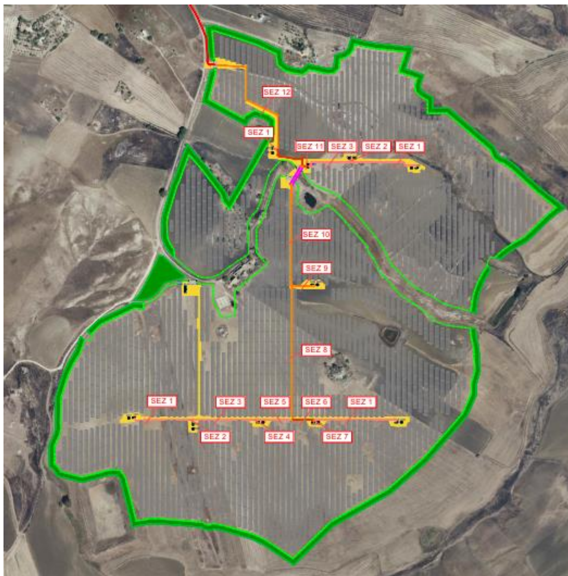
Figura 5-1 – Sezioni per definizione campo magnetico, cavi MT
