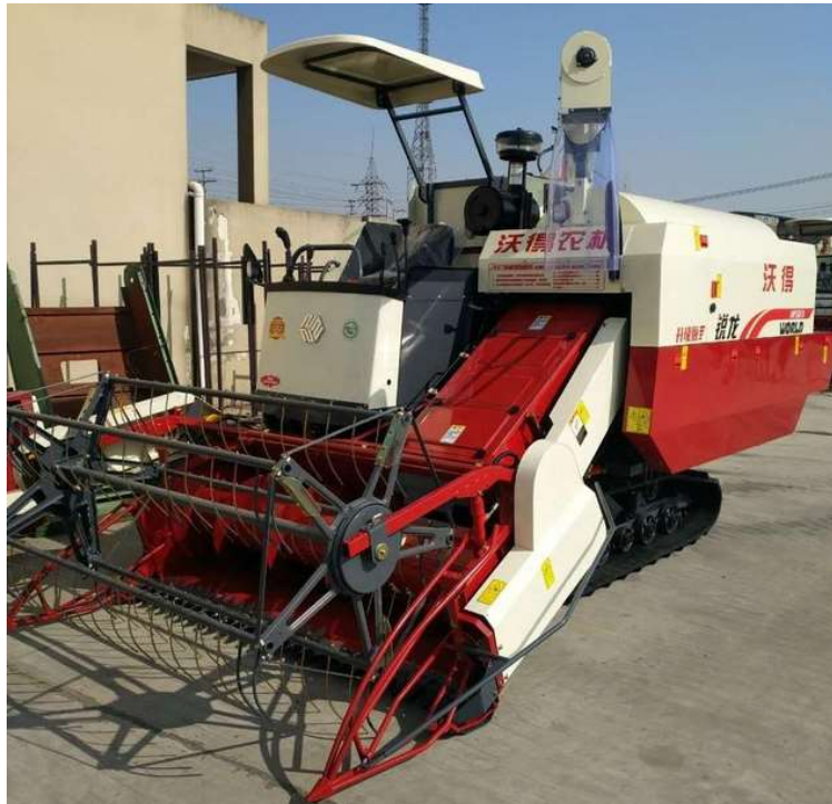
61- esempio di minitrebbia: larghezza di lavoro perfettamente adattabile al contesto in cui si opera
